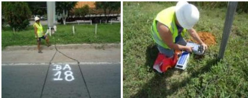
**Figura 9: Dispositivo para a Contagem por Tubos Pneumáticos**
