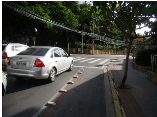
Figura 10. Ciclofaixa com Tachões da Rua Bocaiuva.
