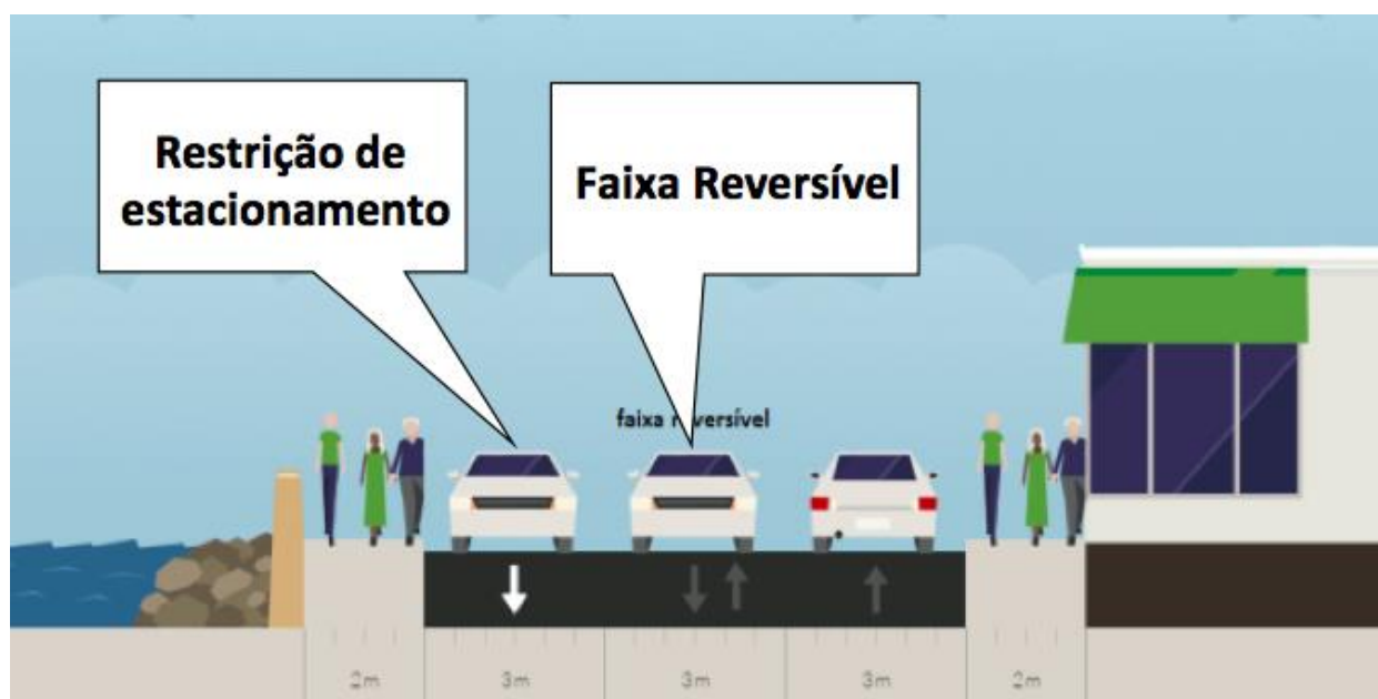
Figura 79 – Seção transversal proposta para a Av. das Rendeiras
