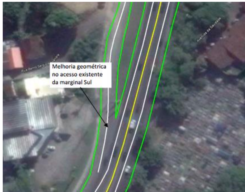
Figura 3-31- Melhoria geométrica do acesso existente da marginal Sul para a rodovia SC-401.
