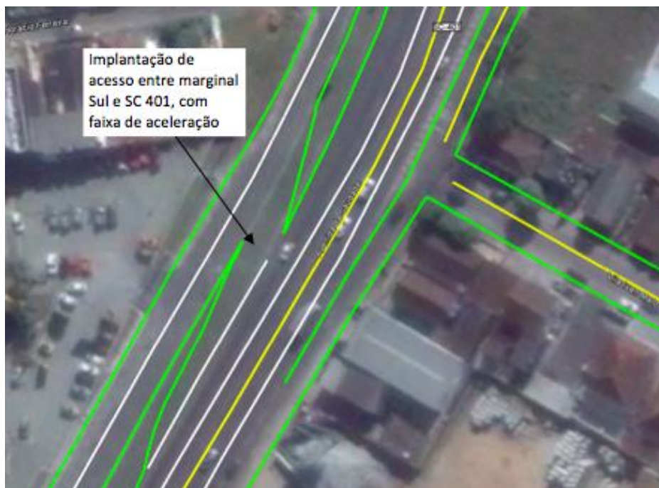
Figura 3-30- Acesso proposto para a marginal Sul da rodovia SC-401.
