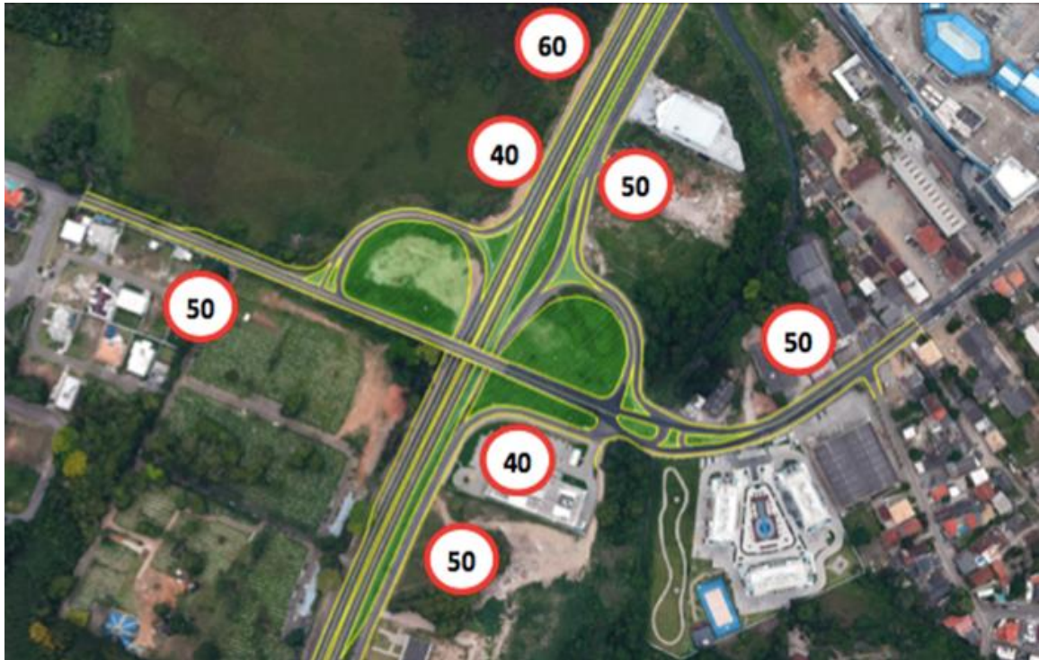
Figura 3-27- Sinalização proposta para o entroncamento entre rodovias SC-401 e João Paulo nas proximidades do Floripa Shopping.
