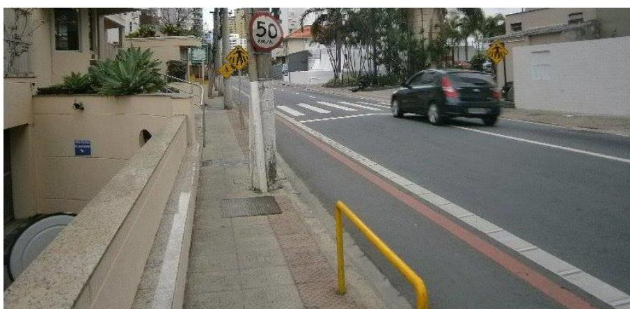
**Figura 3-10. Exemplo de uma ciclofaixa com tachões e unidirecional na Agrônômica**
