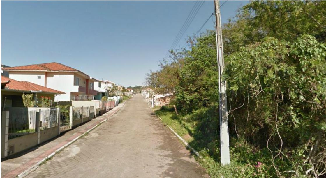
**Figura 83: Exemplo da Falta de Calçada em Terreno Sem Uso, Biguaçu**
