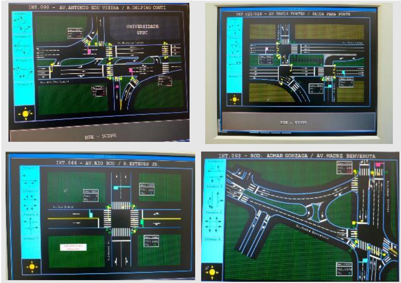
Figura 147 - Detalhe de cruzamentos semaforizados e controlados, com localização dos laços, volume de tráfego e TO
