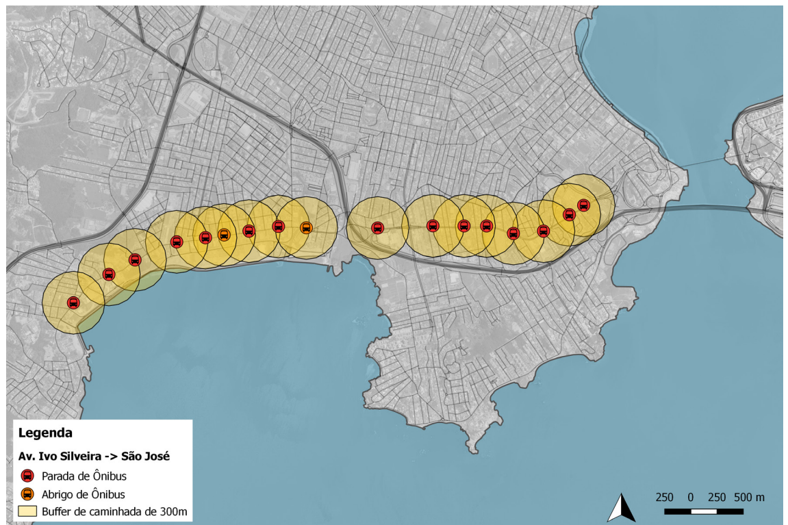
Figura 113. Pontos e paradas de ônibus existentes no Corredor Continental Sul com buffers de 300m, sentido Av. Ivo Silveira - São José.
