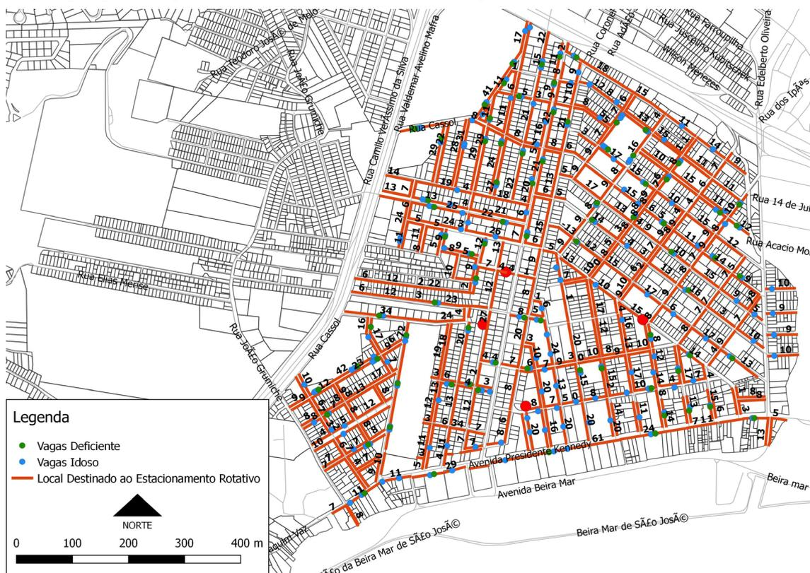
Figura 51. Proposta de inserção de vagas para Kobrasol e Campinas.
