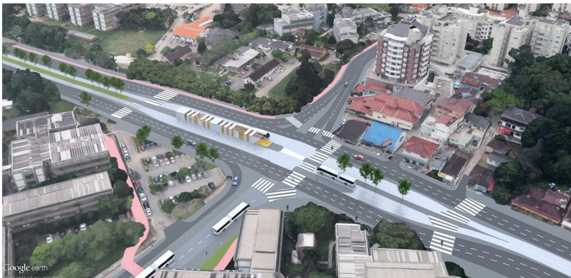
Figura 35. Proposta de inserção de estação de BRT no cruzamento da Dona Benta, nas proximidades da UFSC.
