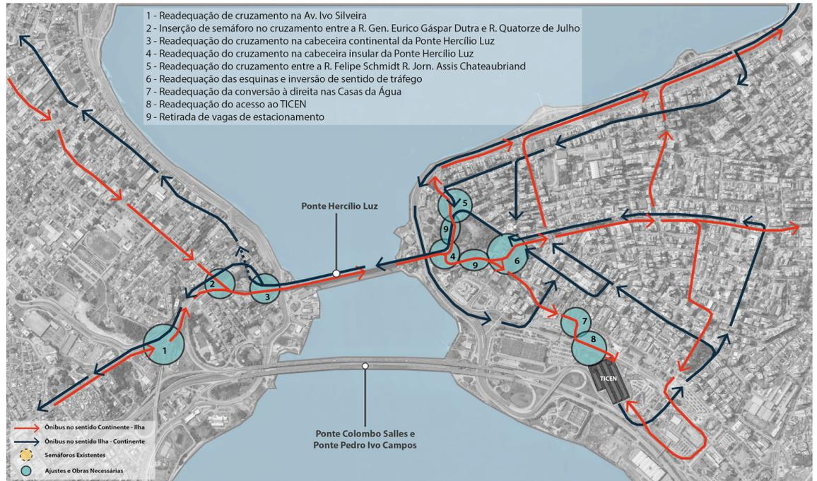
Figura 24. Ajustes e obras necessários nos possíveis trajetos percorridos pelos ônibus para acesso à Ponte Hercílio Luz.
