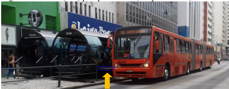
Figura 6 – Detalhe (azul) para plataformas (estação e ônibus) encaixadas.
