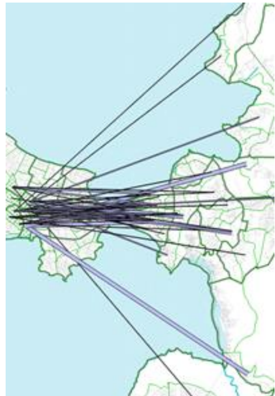
Figura 6: Linhas de desejo existentes para as zonas de tráfego no entorno da Josué di Bernardi
